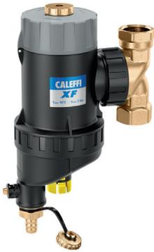
Pot de décantation magnétique avec filtre autonettoyant semi-automatique. Corps en technopolymère. Raccordements filetés femelles. Orientable pour installations horizontales et verticales. Robinet de vidange avec tétine. Pmax d'exercice: 3 bar. Plage de température : 0-90 °C. Diamètre des mailles du filtre Ø = 0,16 mm.
