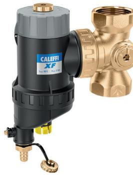
Pot de décantation magnétique avec filtre autonettoyant semi-automatique **avec by-pass**. Corps en technopolymère. Raccordements filetés femelles. Orientable pour installations horizontales et verticales. Robinet de vidange avec tétine. Pmax d'exercice: 3 bar. Plage de température : 0-90 °C. Diamètre des mailles du filtre Ø = 0,16 mm.
