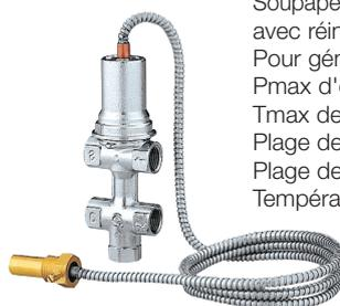
Soupape de sécurité thermique, à action positive, avec réinjection d'eau froide incorporée. Pour générateurs à combustible solide. Pmax d'exercice: 6 bar. Tmax de service : 110 °C. Plage de température : 5–110 °C. Plage de température ambiante : 1–50 °C. Température de tarage : 100 °C (0/-5 °C).
