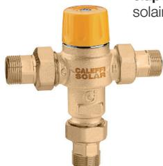
Dispositif à hautes performances thermiques avec sécurité anti-brûlure. Corps en laiton. Raccords union filetés M. Performances conformes à la norme NF 079 doc. 8, EN 15092, EN 1111, EN 1287. Pmax d'exercice: 10 bar. Tmax entrée : 100 °C.
