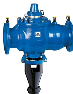
Desconector de zona de pressão reduzida controlável. **Tipo BA.** Corpo em ferro fundido com revestimento em resina epóxi. PN 10. Ligações flangeadas PN 16 para acoplar a contraflanges EN 1092-1. Temperatura máx.: 60 °C. Pressão diferencial de intervenção: 14 kPa. **Certificado segundo a norma EN 12729.** É indispensável instalar a montante o filtro série 579.
