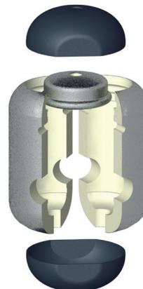
O isolamento com borracha pré-formada a quente garante não só um isolamento térmico perfeito, mas também a hermeticidade à passagem do vapor de água do ambiente para o interior. Por estas razões, este tipo de isolamento também pode ser utilizado em **circuito de água refrigerada**, uma vez que impede a formação de condensação na superfície do corpo da válvula.
