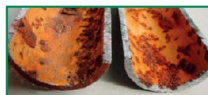
**Incrustações e depósitos na tubagem** podem reduzir significativamente a secção de passagem e, assim, os caudais de fluido.
