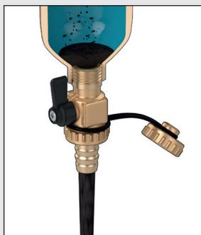
Nas versões roscadas, a câmara de recolha pode ser facilmente inspecionada, desapertando-a do corpo da válvula, para eventual manutenção do elemento interno, em caso de obstrução com fibras ou impurezas de maiores dimensões.
