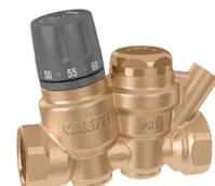
Regulador termostático para circuitos de recirculação de água quente sanitária. Predisposto para função de desinfeção térmica automática ou comandada. Com bainha para termómetro. Corpo em liga "LOW LEAD" antidezincificação CR. Ligações fêmea. Pressão máx.: 16 bar. Campo de regulação temperatura: 35–60 °C.
