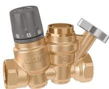
Regulador termostático para circuitos de recirculação de água quente sanitária. Com função de desinfeção térmica automática termostática. Com termómetro para verificação da temperatura do circuito. Corpo em liga "LOW LEAD" antidezincificação CR. Ligações fêmea. Pressão máx.: 16 bar. Campo de regulação temperatura: 35–60 °C. Temperatura de desinfeção: 70 °C.
