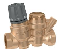
Regolatore termostatico per circuiti di ricircolo acqua calda sanitaria. Predisposto per funzione disinfezione termica automatica o comandata. Con pozzetto per termometro. Corpo in lega "LOW LEAD" antidezincificazione **CR**. Attacchi femmina. Pmax d'esercizio: 16 bar. Campo regolazione temperatura: 35-60 °C.
