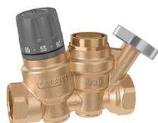
Regolatore termostatico per circuiti di ricircolo acqua calda sanitaria. Completo di funzione disinfezione termica automatica termostatica. Con termometro per verifica temperatura circuito. Corpo in lega "LOW LEAD" antidezincificazione **CR**. Attacchi femmina. Pmax d'esercizio: 16 bar. Campo regolazione temperatura: 35-60 °C. Temperatura di disinfezione: 70 °C.
