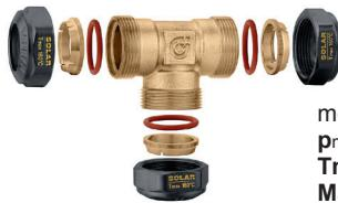
Mehanička spojница s M-priklučkom, s O-Ring brtvom za solarne sisteme. Za cijevi od mekog i tvrdog bakra, mesinga, željeza i nehrđajućeg čelika.  $p_{max}$  radni: 16 bar.
