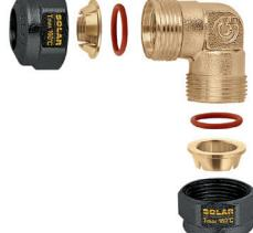
Mehanička kutna spojница, s O-Ring brtvom za solarne sisteme. Za cijevi od mekog i tvrdog bakra, mesinga, željeza i nehrđajućeg čelika.  $p_{max}$  radni: 16 bar.
