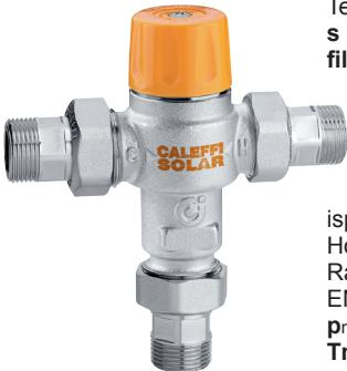
Termostatski mješajući ventil, s nepovratnim ventilima i filterima, za solarne sisteme. S preciznim termičkim mehanizmom. S osiguranjem protiv opeklina. Od mesinga, koji sprječava ispuštanje cinka CR. Kromiran. Holenderski priključci M. Rad po normativu NF 079 dok. 8, EN 15092, EN 1111, EN 1287. p<sub>max</sub> radni: 10 bar. Tmax ulazna: 100°C.
