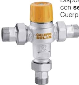
Mezclador termostático regulable con mando, **con válvulas de retención y filtro**. Dispositivo con elevada prestación térmica con **seguridad antiquemaduras**. Cuerpo en aleación antidezincificación **CR**. Cromado.
