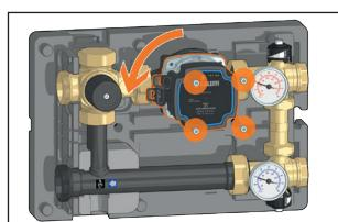
Nelle versioni con circolatore EVOSTA2 ruotare la parte elettronica della circolatore, svitando le quattro viti indicate dalle frecce e ruotando il corpo di 180° in senso orario. Senza eseguire questa operazione, non è possibile reinserire il gruppo nella coibentazione.
