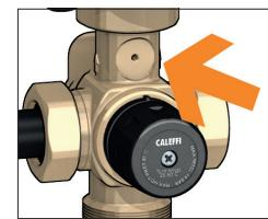
Il kit termostato di sicurezza viene utilizzato per il controllo della massima temperatura di mandata all'impianto. In caso di malfunzionamento, blocca la circolazione fermando la circolatore, prevenendo danni all'impianto. Il bulbo va avvitato nell'apposita sede sulla mandata della valvola miscelatrice.
