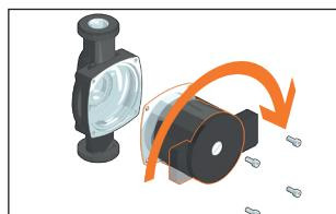
Nelle versioni con circolatore UPML 25-105 ruotare la parte elettronica della circolatore, svitando le quattro viti indicate dalle frecce e ruotando il corpo di 90° in senso antiorario. Senza eseguire questa operazione, non è possibile reinserire il gruppo nella coibentazione.
