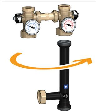
Dans les versions avec circulateur EVOSTA2, tourner la partie électronique du circulateur, en dévissant les quatre vis indiquées par les flèches et en tournant le corps de 180° dans le sens des aiguilles d'une montre. Sans cette opération, il n'est pas possible de replacer le groupe dans la coque isolante.
