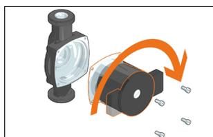
Dans les versions avec circulateur UPML 25-105, tourner la partie électronique du circulateur, en dévissant les quatre vis indiquées par les flèches et en tournant le corps de 90° dans le sens inverse des aiguilles d'une montre. Sans cette opération, il n'est pas possible de replacer le groupe dans la coque isolante.
