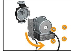
5. Assemblare il gruppo come in figura, serrando completamente le calotte mobili, facendo attenzione a posizionare correttamente le guarnizioni presenti.
