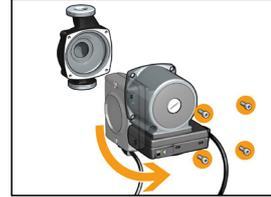
2. Dévisser complètement (avec des clés adaptées) les écrous tournants situés sous les vannes d'arrêt départ et retour. Retirer le circulateur.
