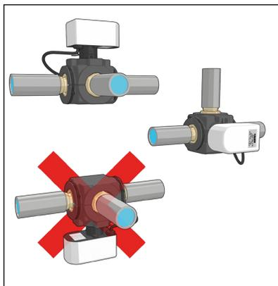
3. Le servomoteur peut être monté sur le corps de la vanne dans les deux positions indiquées. La fixation se fait à l'aide du clip en acier inox.
