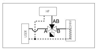
2. La válvula se puede montar con el eje en posición horizontal o vertical, pero nunca en posición invertida.
