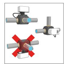
3. El servomando se puede montar en el cuerpo de la válvula en las dos posiciones indicadas. El acoplamiento se realiza con una fijación elástica de acero inoxidable.
