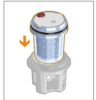
3) Ensamblar el recipiente de sales al cuerpo de la válvula prestando atención en respetar la posición de las ranuras.
