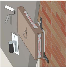
Poklopac pruža referencu za površinu na koju obrada površine zida treba da se nanese da bi se postiglo savršeno uklapanje pokrivne ploče.
