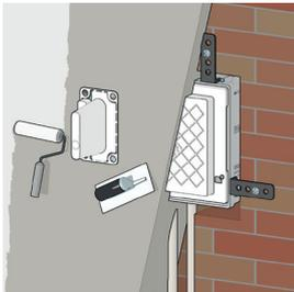
Postavite gips na zid ili zalepite pločice do ivica zaštitne maske.
