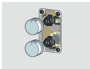
Fissare le manopole tramite le apposite viti di fissaggio e calzare le coperture cromate.
