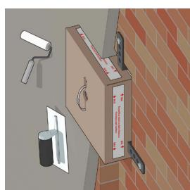
Pokrov služi kao referenca za područje na koje se treba nanijeti površinski završni premaz kako bi se postiglo savršeno povaranjanje pokrovne ploče.
