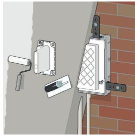
Na zid nanosite gips ili postavljajte keramičke pločice do rubova zaštitne maske.
