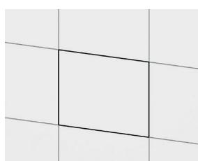
Kontrolni otvor pokrijte gipsom ili keramičkim pločicama kako biste postigli isti efekt korišten na samom zidu.
