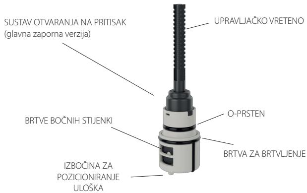
Postoje dvije vrste i veličine uložaka, jedna koja se koristi u razdjelnicima s pojedinačnim zapornim ventilima i jedna projektirana za verzije s glavnim zapornim ventilima. Verzija korištena za glavne zaporne ventile u zidu posjeduje vreteno sa sustavom otvaranja na pritisak. To pomaže da se postigne efekt prikrivanja okretnih gumbi koji se koriste za pomicanje uloška.
