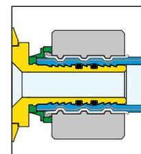
Introduire le tube avec le raccord dans le logement du collecteur.
