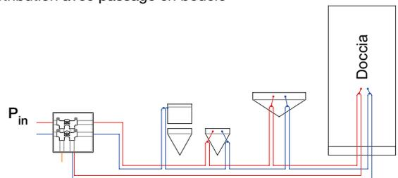
Pour le calcul détaillé des pertes de charge à l'intérieur du circuit en boucle, suivre la méthode de Hardy Cross. Cette méthode s'applique aux réseaux maillés ; le calcul itératif permet de déterminer les pertes de charge réelles plus basses (environ 50 %) par rapport à la méthode simplifiée.
