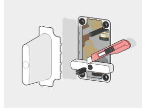
Enlever le masque de protection des vannes d'arrêt et, en utilisant le gabarit intégré, couper les axes afin d'obtenir l'alignement correct des poignées.
