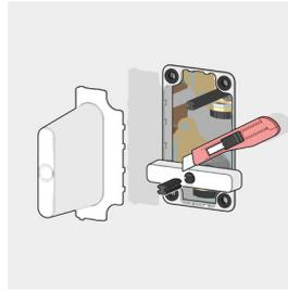
Enlever le masque de protection des vannes d'arrêt et, en utilisant le gabarit intégré, couper les axes afin d'obtenir l'alignement correct des poignées.
