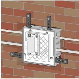
Remplacer le couvercle de protection prévu avant le plâtrage du mur. Utiliser les vis de réglage pour s'assurer que le masque est aligné à ras du mur fini.
