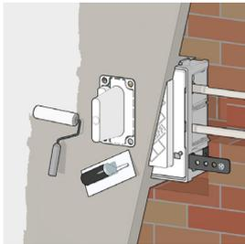
Plâtrer le mur ou poser les carreaux jusqu'au ras du masque de protection.
