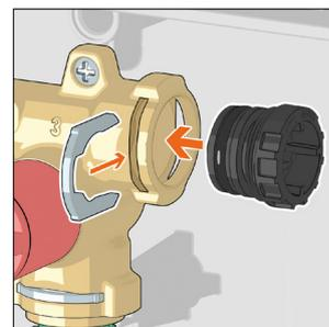
Ce système de raccordement évite toute erreur de montage. Le clip de fixation entre dans le logement uniquement si l'élément à raccorder est dans la bonne position.
