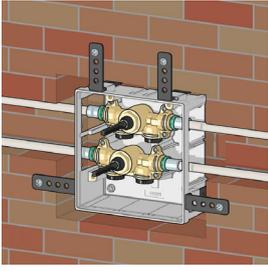
Le coffret peut être installé sur tous types de support mural (maçonnerie, placoplâtre, bois) grâce aux étriers fournis. Une fois le coffret encastré, raccorder les tubes au collecteur en utilisant les raccords à clipser.
