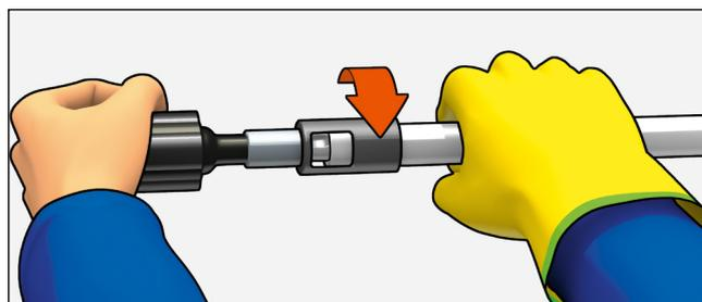
Après avoir calibré le tube à l'aide du calibre, insérer le tube sur le raccord en veillant à l'emboîter complètement. Utiliser le hublot pour vérifier la position correcte du tube.
