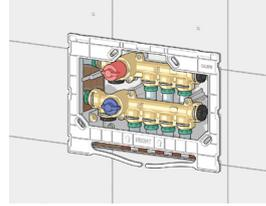
Pour l'installation du couvercle, il faut fixer le gabarit de support au coffret.
