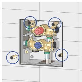
Visser à la main les guides cylindriques sur les orifices du coffret.
