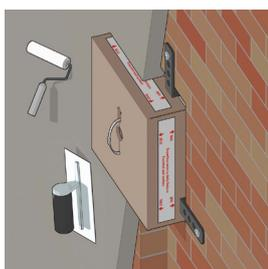
Le couvercle fait office de repère pour la finition superficielle du mur, afin d'aligner correctement la plaque de couverture.
