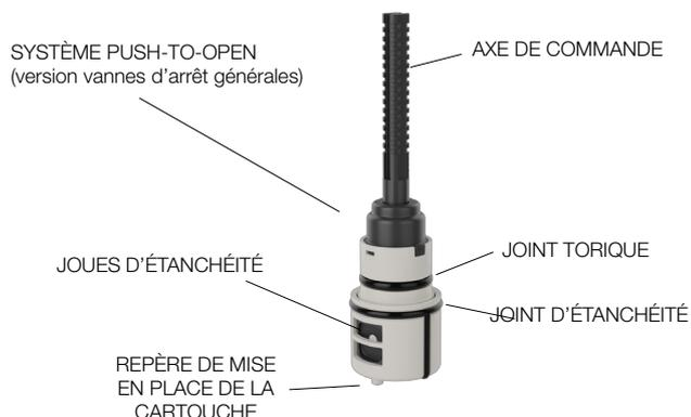
Il existe deux types et deux dimensions de cartouche, l'une pour les collecteurs à vannes d'arrêt individuelles et l'autre pour les versions avec vannes d'arrêt générales. La version utilisée sur les vannes d'arrêt générales encastrées présente un axe avec système push-to-open. Il permet d'escamoter les poignées qui servent à régler la cartouche.
