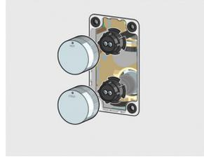
Fixer les poignées à l'aide des vis de fixation et clipser les couvertures chromées.
