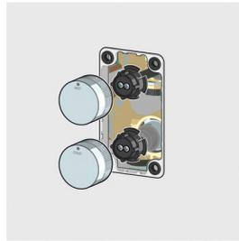
Fixer les poignées à l'aide des vis de fixation et clipser les couvertures chromées.
