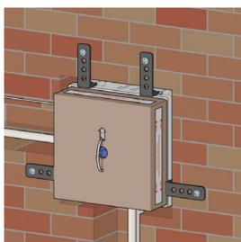
Le couvercle de protection permet de protéger l'intérieur du coffret pendant l'installation.
