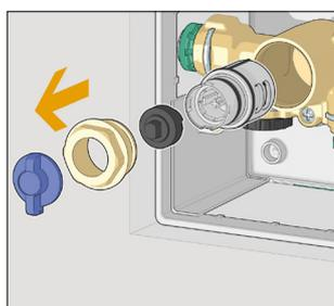
Sur les versions avec vannes d'arrêt générales inspectables, le système push-to-open est remplacé par la même poignée que celle utilisée pour les vannes d'arrêt individuelles.
