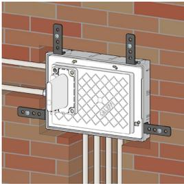
Replacer le couvercle de protection prévu avant le plâtrage du mur. Utiliser les vis de réglage pour s'assurer que le masque est aligné à ras du mur fini.
