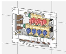
Pour l'installation du couvercle, il faut fixer le gabarit de support au coffret.
