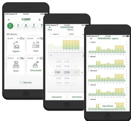
La communication entre les dispositifs se fait par ondes radio et la Gateway est le cerveau de tout le système. Elle interagit via le réseau Internet avec l'appli CALEFFI CODE® afin de contrôler et de gérer le chauffage du logement en fonction de la programmation et des exigences de l'utilisateur, en communiquant avec les têtes et les capteurs.
