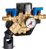
Groupe compact de remplissage automatique conforme à la norme EN 1717 avec disconnecteur type BA, vannes d'arrêt, filtre, prises de pression pour contrôle du disconnecteur, réducteur de pression. Pour installation horizontale ou verticale. Corps en laiton. Avec coque d'isolation. Plage de réglage de l'alimentateur automatique : 0,8–4 bars. Pmax d'exercice : 10 bar. Tmax d'exercice : 65 °C. Disconnecteur conforme à la norme EN 12729. Réducteur de pression conforme à la norme EN 1567.
