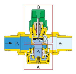
a) Il dispositivo **(A)** controlla e mantiene costante il  $\Delta p_i$  ( $p_2$ - $p_3$ ), ai capi del dispositivo **(B)**, con azione automatica (equilibrio tra forza generata dal differenziale di pressione e molla di contrasto interna). Se ( $p_1$ - $p_3$ ) aumenta, il regolatore di  $\Delta p$  interno reagisce per chiudere il passaggio e mantenere ( $p_2$ - $p_3$ ) = costante; in queste condizioni la portata rimarrà costante.
