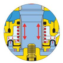
b) Il dispositivo **(B)** controlla la portata G, modificando la sua sezione di passaggio. La variazione della sezione di passaggio determina il valore di caratteristica idraulica (Kv) del dispositivo di controllo **(B)**,che si mantiene costante su:
