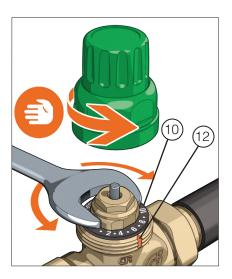
La rotazione della ghiera (10) che determina il numero relativo alla "**Posizione di regolazione**", provoca l'apertura/chiusura della sezione di passaggio ricavata sull'otturatore esterno (13). Quindi, ad ogni sezione di passaggio regolata sulla ghiera, corrisponde un determinato valore della **Gmax**<sub>x</sub>.
