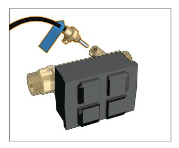
Inserire il misuratore di portata al posto della dima precedentemente rimossa e serrare le calotte. Piombare il misuratore di portata ultrasonico.
