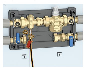
Inserire la sonda di ritorno nell'apposito attacco sul misuratore di portata ultrasonico come da figura, procedere alla sua piombatura.
