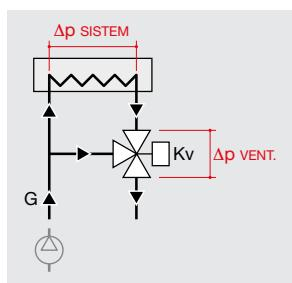
V teh dveh tipih tokokrogov se za regulacijo pretoka skozi krog sistema uporablja dvopotni ali tripotni preusmeritveni ventil. V takšnih primerih je pomembno, da z dimenzioniranjem regulacijskega ventila dobite dober koeficient regulacije, ki zagotavlja, da padec tlaka v primerjavi s padcem tlaka v tokokrogu sistema ni prenizek. Priporočene vrednosti za hitro dimenzioniranje se lahko izberejo z upoštevanjem:
