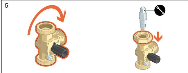
6. Ruotare manualmente l'indicatore di posizione.
