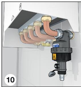
Der Schlammabscheider Art.Nr. 545135 (Abb. 11) ermöglicht den Anschluss mit Winkelstück.
