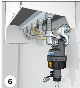
Der Schlammabscheider Art.Nr. 545455 und 545255 (Abb. 7, 8 und 9) ist speziell für den Einbau unter Vaillant-Wandheizgeräten mit horizontalen Anschlüssen ausgerüstet.
