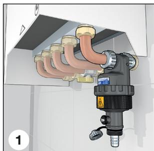
Der Schlammabscheider Art.Nr. 545105 und 545205 werden dann eingesetzt, wenn die Wandanschlüsse nicht entsprechend den Anschlüssen des Wandheizungsgerätes (2 und 3) ausgerichtet sind oder wenn ein größerer Freiraum unterhalb des Heizgerätes (4) notwendig ist. Die Anschlüsse werden dann mit Edelstahl-Schläuchen ausgeführt.
