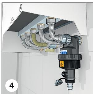
Wenn der Raum unter dem Heizgerät die Verwendung des Rohr-Kits nicht zulässt, ermöglicht der "S"-Anschluss des Schlammabscheiders Art.-Nr. 545205, einen größeren Freiraum für die Ausführung von Arbeiten unter dem Wandheizungsgerät, da der Schlammabscheider (Abb. 5 und 6) dadurch tiefer positioniert wird. Die Anschlüsse werden dann mit Edelstahl-Schläuchen ausgeführt.
