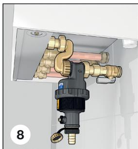
Der Schlammabscheider Art.Nr. 545122 (Abb. 10) ermöglicht den Anschluss an das Heizungsgerät über Kupferrohr  $\varnothing 22$ , wobei die Rohrleitung getrennt und der Schlammabscheider direkt zwischen den Rohrenden eingebaut wird.
