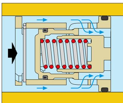
Liegt der Differenzdruck innerhalb des Arbeitsbereichs, drückt der Kolben die Feder zusammen und bietet dem Medium einen freien Durchgangsquerschnitt, der für den AUTOFLOW vorgegebene reguläre **Nenndurchflussmenge** ermöglicht.
