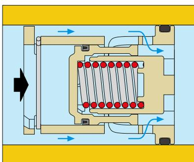
In diesem Arbeitsbereich drückt der Kolben die Feder vollständig zusammen und lässt das Medium nur durch die feststehende Öffnung durchfließen.
