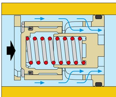
In diesem Fall bleibt der Reglerkolben im Gleichgewicht, ohne die Feder zusammen zu drücken und bietet dem Medium den maximal freien Durchgangsquerschnitt. Der Kolben wirkt praktisch wie ein fester Regler, d. h., die durch den AUTOFLOW strömende Durchflussmenge hängt nur vom Differenzdruck ab.
