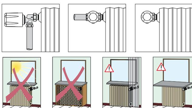
Les têtes électroniques programmables **doivent être installées en position horizontale** afin de permettre à la sonde interne de relever correctement la température.
