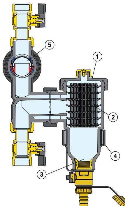
Voda koja cirkuliše u sistemu teče, prolazi prvo kroz odvajač nečistoća (1), a zatim kroz uložak filtera (5). Prvi prolaz kroz odvajač nečistoća omogućuje izdvajanje visokog procenta nečistoće u cirkulirajućoj vodi, sve do minimalnih veličina čestica. Medijum tada teče kroz uložak u kojem je 100% preostalih čestica, čiji je prečnik veći od veličine mreže, mehanički se presreću. Efikasnost odvajača nečistoća je nakon malog broja recirkulacije toplotnog medijuma na vrhuncu nazivnog rada sistema.
