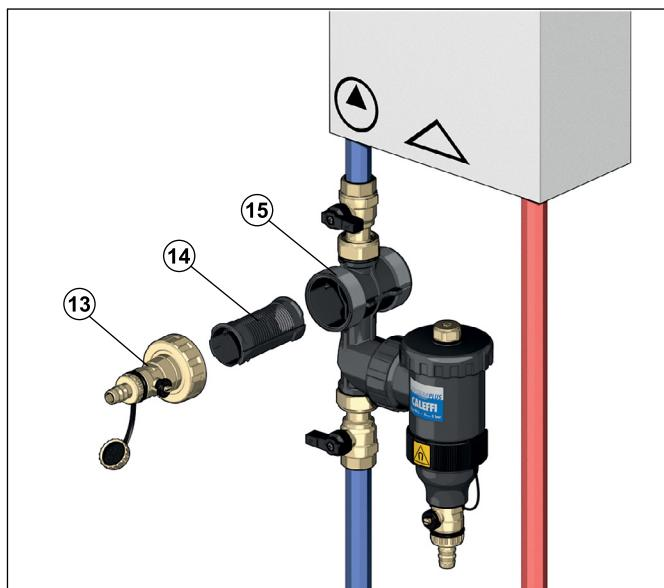
Komplet dodatne opreme za punjenje i ispiranje kruga (kod F49476) sastoji se od čepa sa odvodnim ventilom (13) i crno obojeni element (14) koji će se staviti u posuda za filter (15) za razdvajanje tokova.
