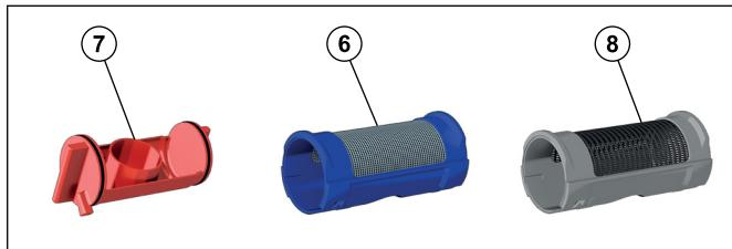
Isporučeni filter (plave boje) sastoji se od metalne mrežice sa kapacitetom filtracije delica većih od 0,3 mm. Ova specijalna pletena mreža izdvaja sve čestice koje cirkulišu i na taj način obezbeđuje optimalno čišćenje cevi. Nakon gašenja i isušivanja uređaja DIRTMAGPLUS®, uložak 6 može se lako pregledati i pratiti:
