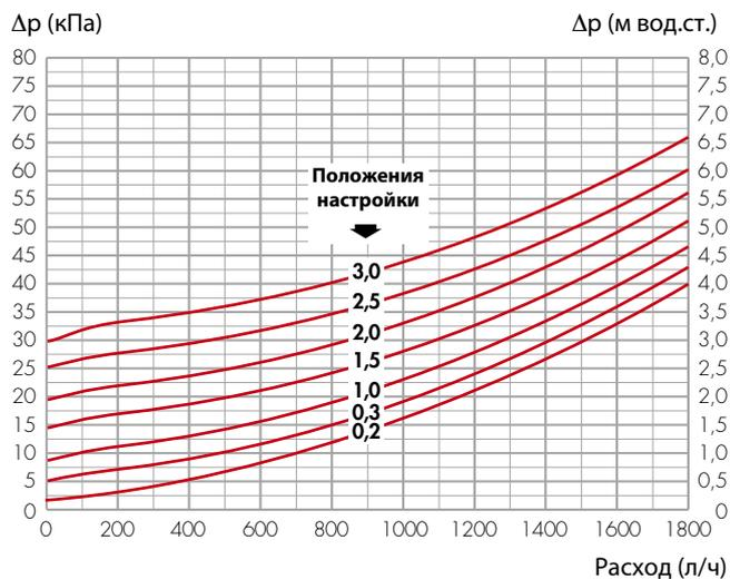
Гидравлические характеристики получены с учетом наличия шаровых клапанов-отсекателей.
