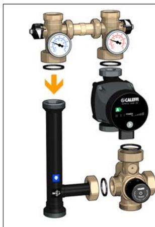
3. Открутить заглушку, расположенную справа от смесительного клапана и закрутить её на противоположную сторону.
