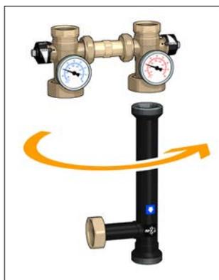
**На моделях с насосом UPML 25-95 необходимо вращать электронную часть насоса, открутив четыре шурупа, указанные стрелками, и вращая корпус на 90° против часовой стрелки. Без выполнения данной операции невозможно заново установить группу в изоляционный кожух.**
