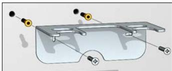
Группа накладывается на кронштейн, с использованием специальных посадочных мест имеющихся под шестигранной частью клапанов-отсекателей.
