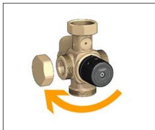
4. Установить соединительную трубку справа, повернув её на 180° по своей оси.
