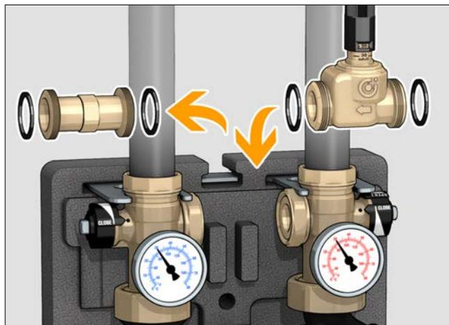
Монтаж отличается в зависимости от направления потока на подаче:
