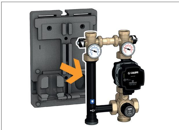
2. Dévisser complètement (avec des clés adaptées) les écrous tournants situés sous les vannes d'arrêt de départ et de retour. Dévisser également les écrous tournants situés sur la vanne mélangeuse puis démonter la vanne et le circulateur.
