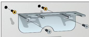
Appliquer le groupe sur l'étrier en utilisant les sièges présents sous la partie hexagonale des vannes d'arrêt.
