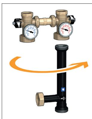
Dans les versions avec circulateur UPML 25-105, tourner la partie électronique du circulateur, en dévissant les quatre vis indiquées par les flèches et en tournant le corps de 90° dans le sens inverse des aiguilles d'une montre. Sans cette opération, il n'est pas possible de replacer le groupe dans l'isolant.
