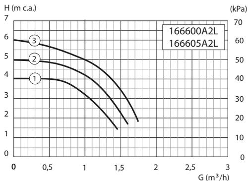
Essais effectués avec contrôle à pression constante.
