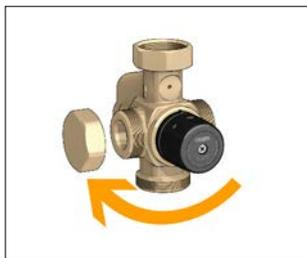
4. Die Anschlussleitung durch Drehung um 180° auf der eigenen Achse nach rechts versetzen.
