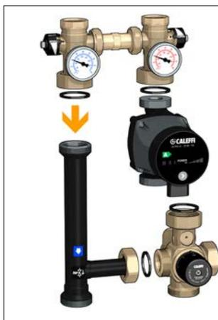
3. Den Verschluss an der rechten Seite des Mischventils abschrauben und an der gegenüberliegenden Seite einschrauben.
