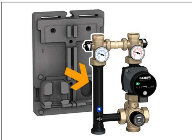
2. Die abnehmbaren Überwürfe unter den Absperrventilen des Vor- und Rücklaufs vollständig abschrauben (mit geeigneten Schlüsseln). Anschließend auch die abnehmbaren Überwürfe am Mischventil abschrauben und das Ventil und die Pumpe entnehmen.
