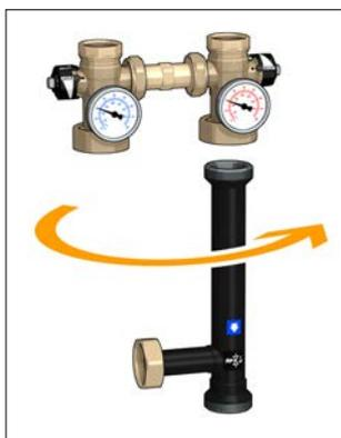
Bei den Versionen mit Pumpe UPML 25-95 den elektronischen Teil der Pumpe drehen, indem man die vier durch die Pfeile gekennzeichneten Schrauben ausdreht und das Gehäuse um 90° gegen den Uhrzeigersinn dreht. Wird dieser Vorgang nicht ausgeführt, ist es nicht möglich, die Gruppe wieder in die Isolierung einzufügen.
