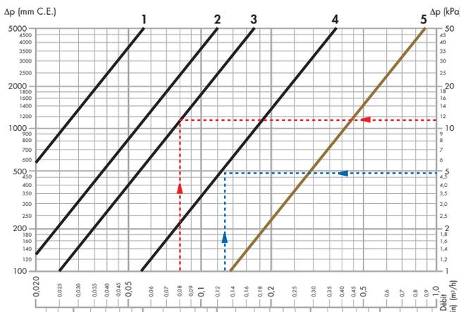
Lorsque l'on rajoute une tête thermostatique, la perte de charge du circuit augmente d'environ 0,03 bar.
