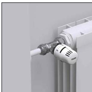
L'élément sensible des têtes thermostatiques ne doit pas être installé dans : des niches, des coffrets, derrière un rideau, ou bien à l'exposition directe du rayonnement solaire qui fausserait la valeur de température relevée.
