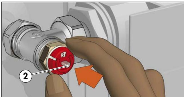
D. Positionner la poignée manuelle (1), la tête thermostatique (2) ou électrothermique (3) sur le robinet.
