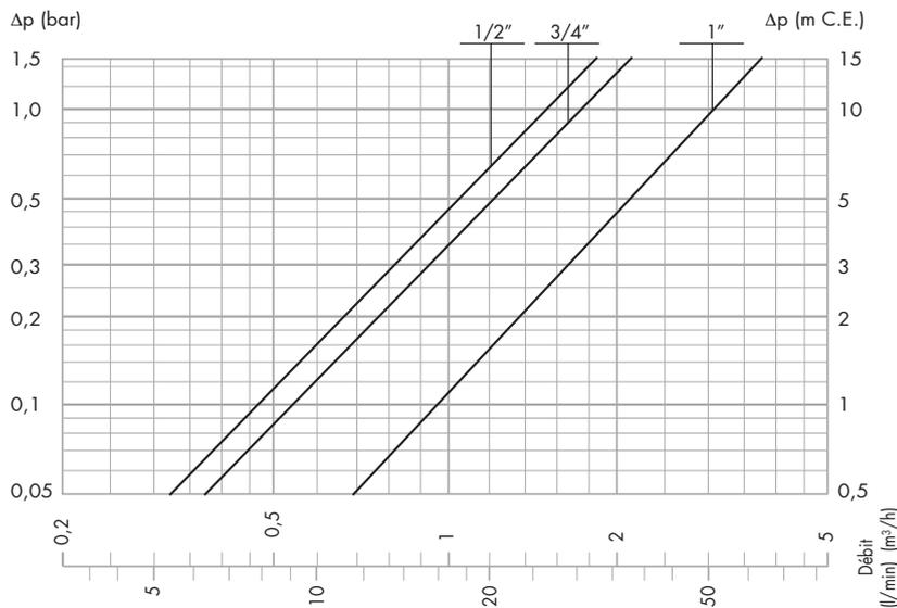
**Débit conseillé pour garantir un fonctionnement stable et une précision  $\pm 2^\circ\text{C}$**
