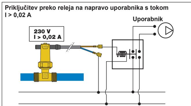
**OPOMBA:** Priporočeno je biti pozoren na vrednost toka naprave uporabnika na katero je priklučeno pretočno stikalo. Če je ta vrednost višja od **0,02 A**, je potrebno med pretočno stikalo in napravo namestiti rele zato, da preprečite poškodbe na kontaktih pretočnega stikala.
