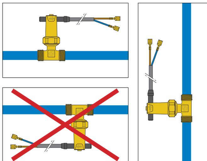
Pretočno stikalo serije 315 lahko namestite horizontalno ali vertikalno, vendar stikalo pri tem ne sme biti obrnjeno navzdol. Zgornji del pretočnega stikala, kjer se nahaja magnetni mehanizem, je togo pritrjen na ohišje in ga zaradi tega ni mogoče odstraniti.
