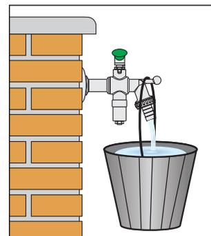
Il filetto di uscita del rubinetto è stato realizzato in modo tale da permettere il collegamento diretto dei portagomma e degli accessori normalmente utilizzati con le tubazioni flessibili da giardino, per un facile ed agevole utilizzo.
