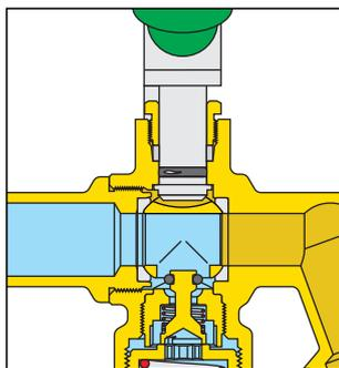
La sede di scarico del dispositivo antigelo è in acciaio inox, per garantire l'ermeticità del dispositivo, senza problemi di corrosione dovuta al contatto con l'acqua di scarico.
