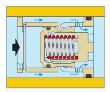
In questo campo di lavoro, il pistone comprime completamente la molla e lascia solo l'apertura a geometria fissa come via di passaggio per il fluido.
