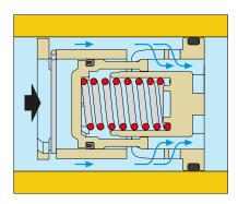
Se la pressione differenziale è compresa nel campo di lavoro, il pistone comprime la molla ed offre al fluido una sezione di libero passaggio tale da consentire il regolare flusso della portata nominale per cui l'AUTOFLOW® è
