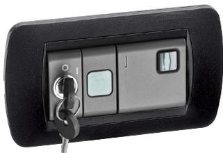
Timer con chiave di consenso programmabile da 0,25 a 15 minuti. Per azionamento di valvole utilizzate per effettuare la disinfezione termica di tratti di circuito, fino ai rubinetti. Alimentazione: 230 V (ac).
