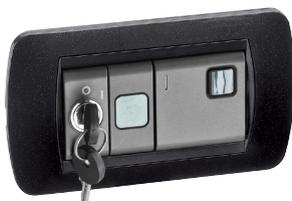
Minuteur à clé d'autorisation programmable de 0,25 à 15 minutes. Permet d'actionner les vannes pour la désinfection thermique des circuits ECS jusqu'aux robinets. Peut commander jusqu'à 2 têtes électrothermiques. Alimentation électrique : 230 V (~). Puissance absorbée : 3W
