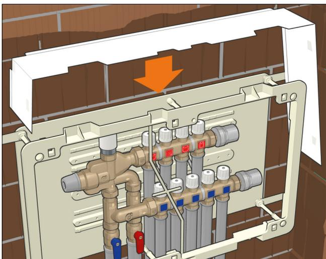
Le couvercle permet de récupérer 30 mm de profondeur en cas d'erreurs possibles des finitions de maçonnerie.
