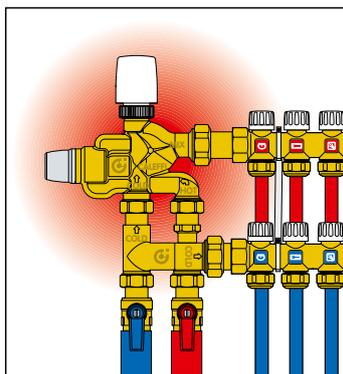
Ce risque reste possible sur un système traditionnel comprenant un mitigeur et une vanne de by-pass raccordés par des tuyaux. Une partie du mitigeur qui est toujours en contact avec l'eau froide ne dépasse pas une certaine température, ce qui n'assure pas sa désinfection totale. De plus, en fonctionnement normal, le by-pass devient un bras mort.
