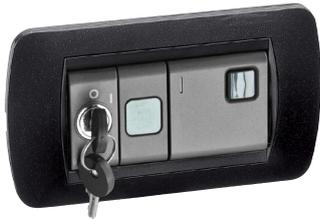
Temporizador con llave de habilitación programable entre 0,25 y 15 minutos. Controla el accionamiento de las válvulas utilizadas para la desinfección térmica de tramos de circuito, hasta los grifos. Alimentación: 230 V (ac).
