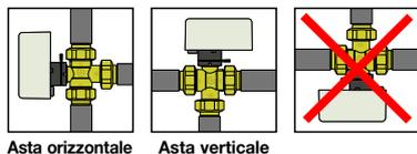
2b. Nel caso di installazioni con acqua refrigerata, con rischio formazione condensa, il servocomando deve essere installato con asta di comando verticale.
