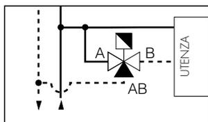
2. La valvola va installata con l'asta di comando in posizione orizzontale oppure verticale, **mai in posizione rovesciata**.
