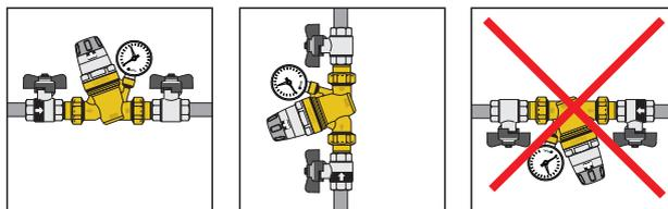
2. O particular sistema de regulação mecânico, com manípulo e indicador de pressão visível dos dois lados, permite efectuar a regulação do grupo no valor desejado antes do início da fase de enchimento.
