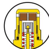
Il principio di funzionamento del tappo igroscopico di sicurezza si basa sulla proprietà dei dischi in fibra di cellulosa che formano la cartuccia di tenuta. Detti dischi incrementano del 50% il proprio volume nel momento in cui vengono bagnati dall'acqua, chiudendo la valvola. Si evitano così possibili danni in caso di perdite d'acqua.
