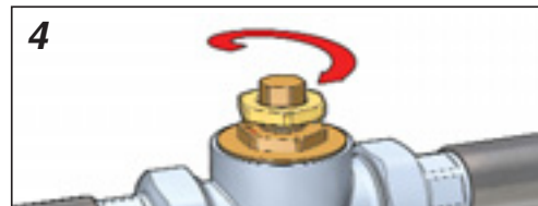
Blocage du réglage par contre-écrou
