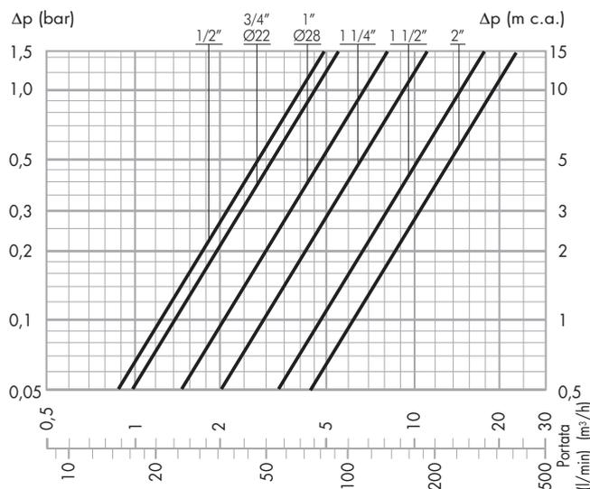
**PORTATE** consigliate per garantire funzionamento stabile e precisione di  $\pm 2^\circ\text{C}$
