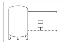
Per gli impianti sanitari, l'installazione corretta è sulla tubazione di alimentazione acqua fredda in ingresso.
