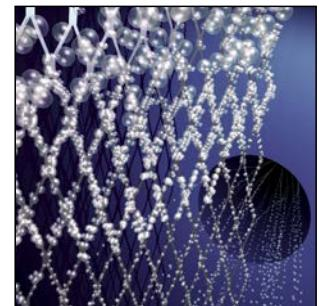
As bolhas, fundindo-se, aumentam de volume até que são empurradas pela força hidrostática, que é superior à sua força de adesão à estrutura. Sobem, assim, em direção à parte alta do dispositivo, da qual são evacuadas através de um purificador de ar automático com boia (2). Foi projetado de modo a que o sentido do fluxo do fluido termovetor resulte indiferente.
