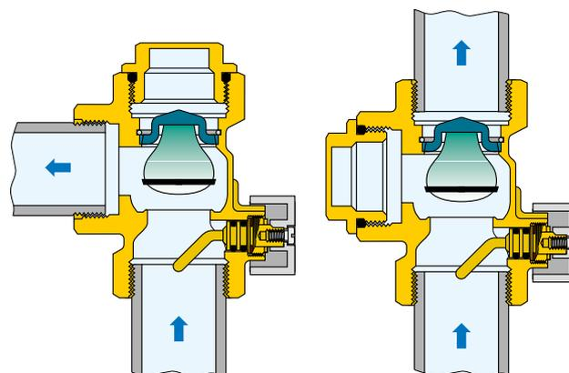
A válvula deve ser instalada respeitando o sentido de fluxo indicado pela seta no corpo da válvula. A válvula pode ser instalada utilizando ligações direitas ou em esquadria, removendo simplesmente a tampa de vedação da terceira via. A válvula deve ser instalada com o eixo de retenção na vertical, segundo um dos dois esquemas apresentados.
