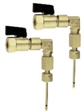
Par de adaptadores com seringa de engate rápido para ligação das tomadas de pressão aos instrumentos de medição. Ligação roscada 1/4" fêmea. Pressão máx.: 10 bar. Temperatura máx.: 110°C.
