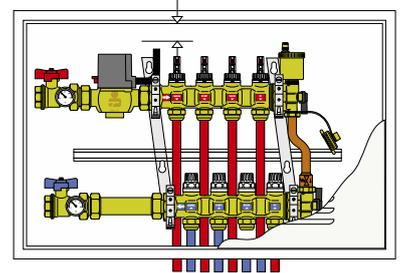
Installazione in cassetta serie 659, con kit eccentrico serie 6480 per il collegamento al tee di by-pass per l'accoppiamento della valvola di zona con collettori semplici.
