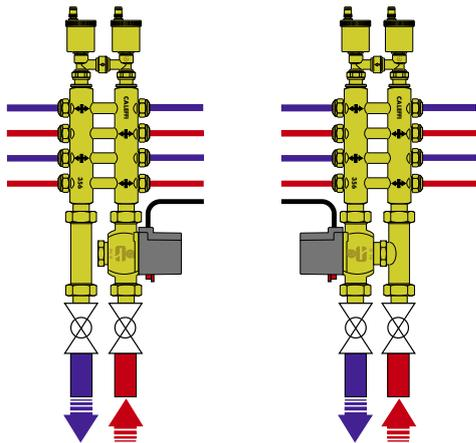
3. Per il montaggio delle valvole di zona serie 632 e 633 sull'impianto occorre rispettare il senso di flusso indicato sul corpo. Le valvole non vanno mai collegate con lo stelo rivolto verso il basso.
