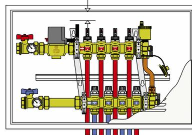
Installazione in cassetta serie 659, con kit eccentrico serie 6480 per il collegamento al tee di by-pass per l'accoppiamento della valvola di zona con collettori semplici.
