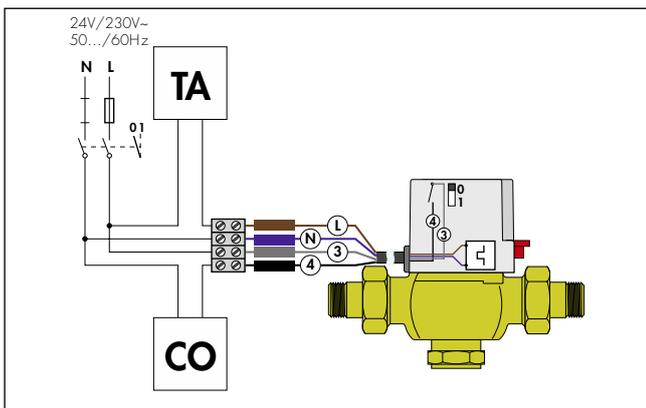
Il microinterruttore ausiliario può essere utilizzato, come in questo schema, per il disinserimento della pompa quando nessuna zona risulta in funzione. In tal caso i contaore vanno collegati in parallelo con l'alimentazione elettrica della valvola di zona. Si noti che se l'assorbimento della pompa supera la portata dei contatti di 6 (3) A, va utilizzato un teleruttore intermedio. Lo schema utilizza la versione del comando elettrotermico con cavetto a quattro fili.
