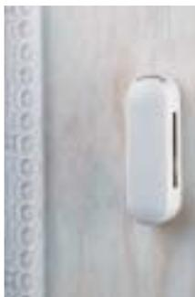
A utilização do comando termostático com sensor à distância série 201 é necessário quando a válvula é instalada em nichos, recantos, atrás de cortinas ou exposta directamente a raios de sol; de facto estes factores podem influenciar a boa regulação da temperatura ambiente.
