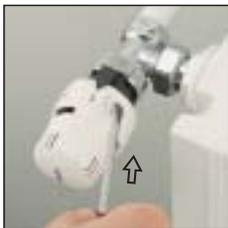
**1.** Com a ajuda de uma chave de parafusos soltar o anel branco da extremidade inferior da cabeça na direcção do corpo da válvula até ao fim.
